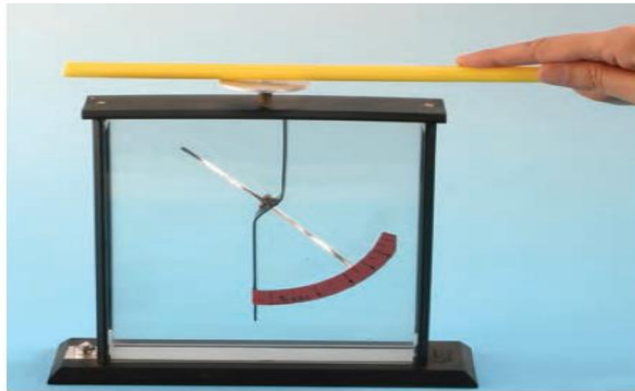
ب) جسمی باردار را به کلاهک الکتروسکوپ بدون بار نزدیک کرده یا تماس داده ایم.
