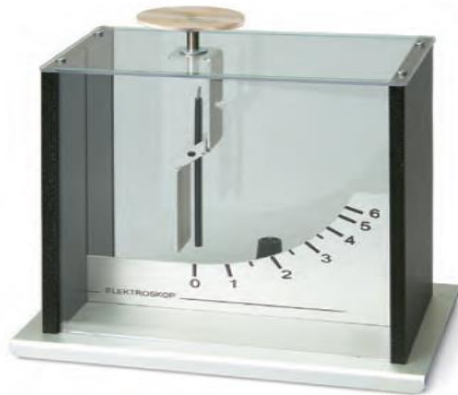
الف) تصویری از یک الکتروسکوپ درجه بندی شده بدون بار
